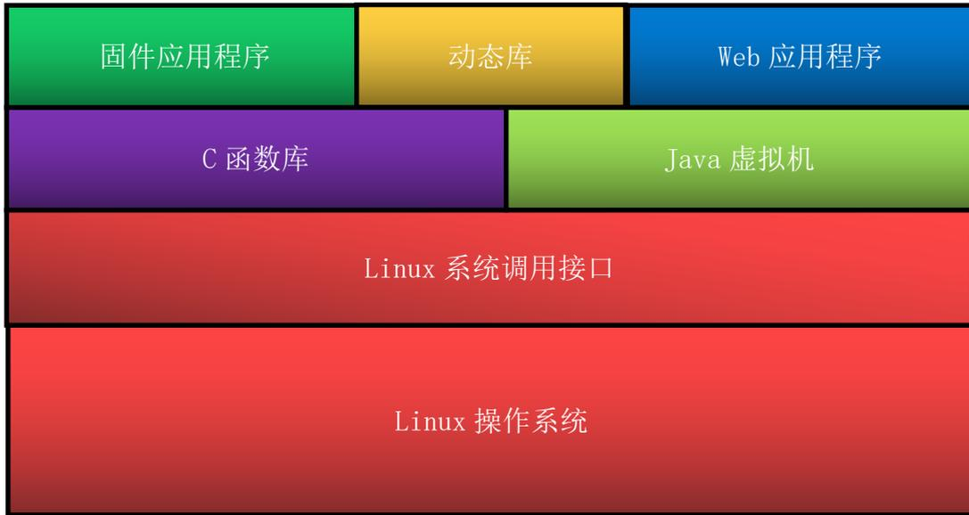
图 1.5 M300Pro 软件方案构成图
